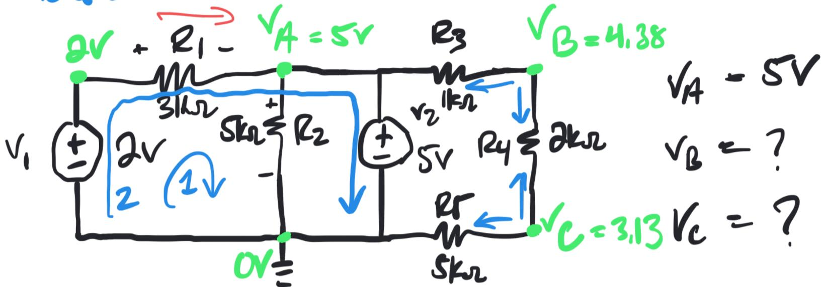
$$\text{at node B: } \frac{V_B - 5V}{1k\Omega} + \frac{V_B - V_C}{2k\Omega} = 0$$
