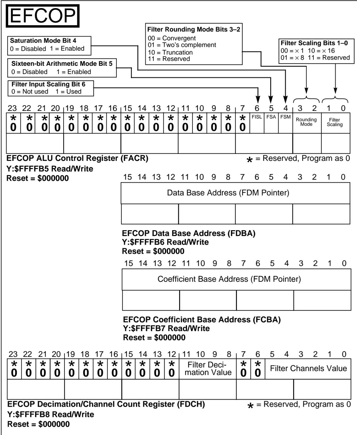
Figure 5-2. EFCOP FACR, FDDBA, FCBA, and FDCH Registers
